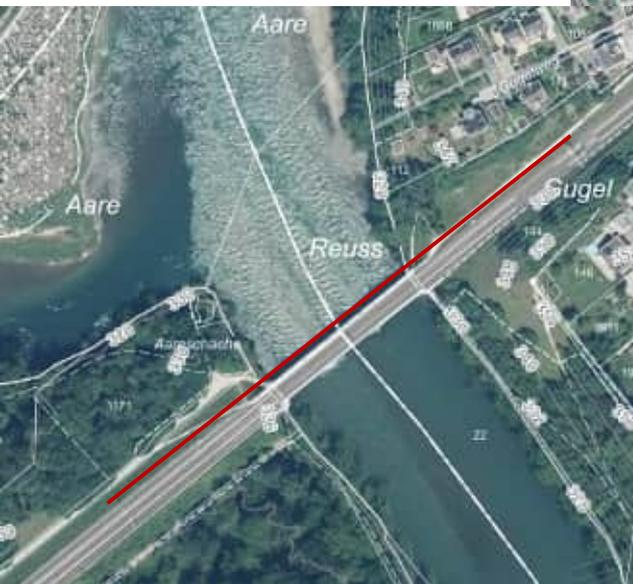
Reussbrücke muss saniert werden: Steg verbreitern (von 1m auf 2.5m ?) und für Veloverkehr öffnen. Gehweg von 1.5m auf 6m, Velo-Fussweg von 2m auf 3m verbreitern (?)
